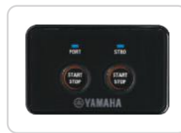
3 - CONTACTEUR BIMOTEUR START/STOP
